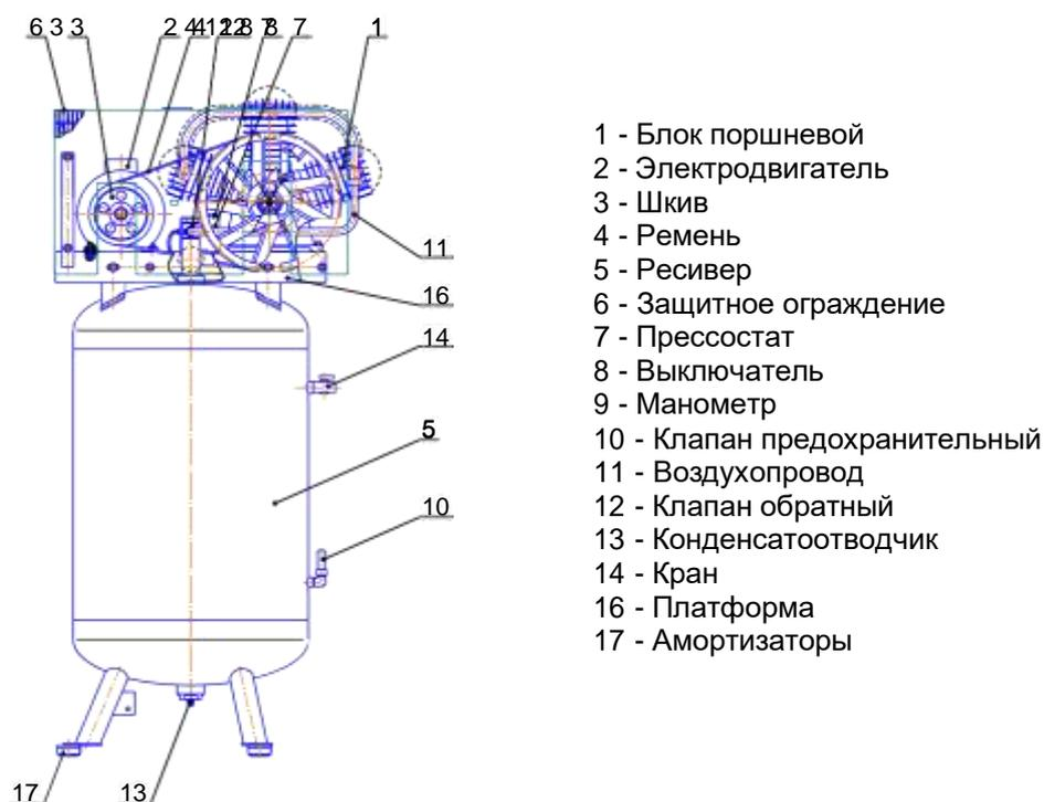
Рисунок 10 - Общий вид компрессора СБ4/Ф-270.LB40В
